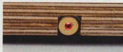
Rotlicht-Laser und Sensor sind an den Innenseiten der Schenkel angebracht
