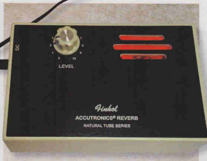
Dank roter LED gut erkennbar: die ECC82-Röhre
